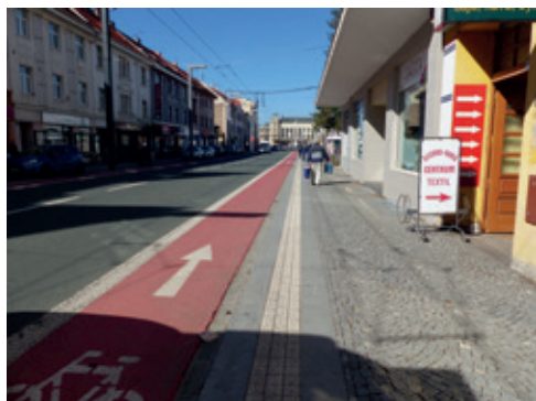
Obr. 11 hmatný pás mezi cyklostezkou a chodníkem
